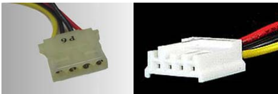
De izquierda a derecha, molex para discos duros IDE y unidades ópticas. A la derecha, conector de alimentación de disquetera.
