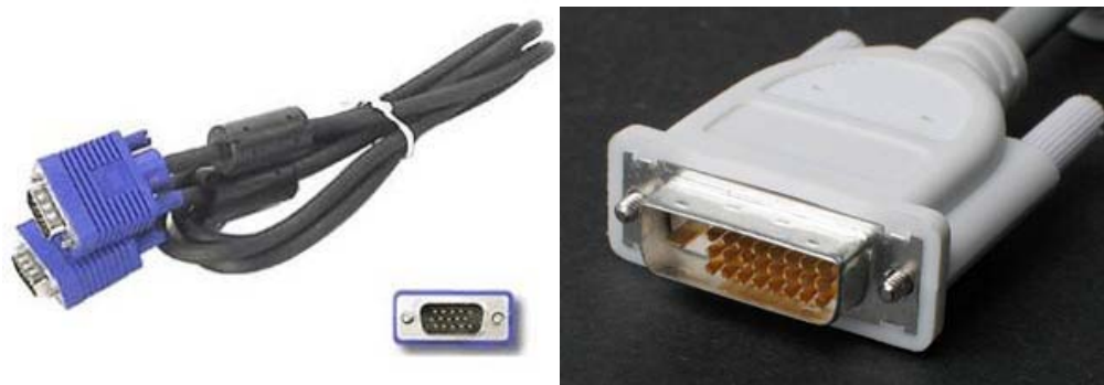
A la izquierda, un conector VGA. A la derecha, un conector DVI.
