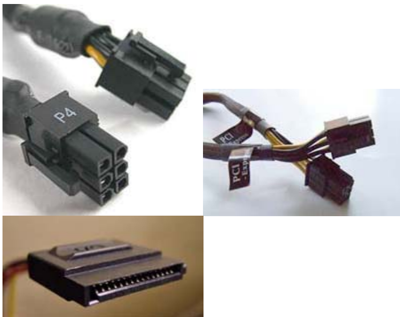
De izquierda a derecha, conectores de 4 y 6 pines de 12 v, conectores de alimentación para gráficas PCIe y conector de alimentación SATA.
