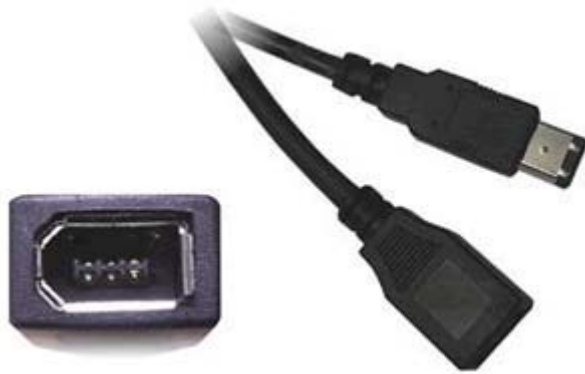
Imagen de unos conectores IEEE1394 de 6 contactos.
