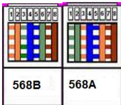
Esquema de posicionamiento de los hilos en los conectores RJ-45.
