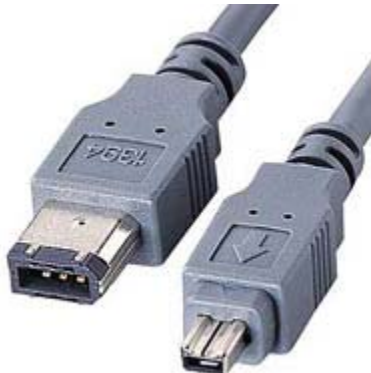
Imagen de dos tipos de conectores IEEE1394, uno estándar y otro mini.
