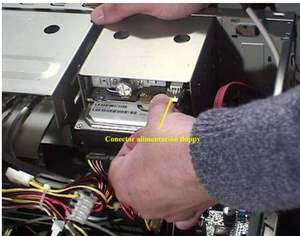
Fig. 12.1 Alimentación de disquetera
