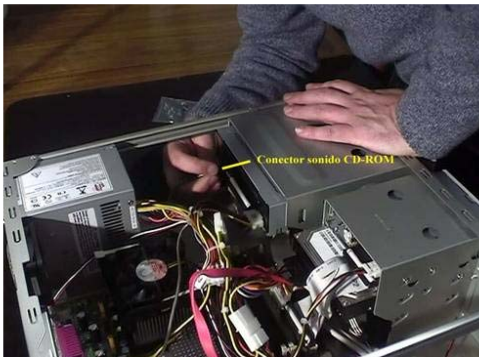
Fig 15.1 Conector sonido CD-ROM
